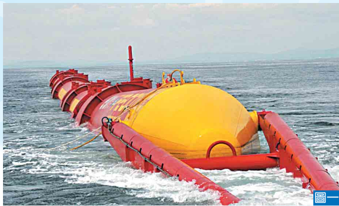
▲英國名為「海蛇」(PELAMIS)的海洋發電設備，利用波的傳導，將液體壓過發電渦輪，再將電力傳回陸地。
